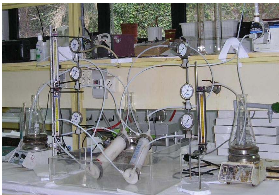
Figura 2-8. Fotografía del montaje de extracción no dispersiva en el laboratorio
