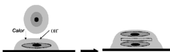
Figura 5-6: Cristalización de la fase amorfa previamente solidificada debido al calor de la siguiente partícula que se deposita y de la rehidroxilación durante la formación del recubrimiento.
