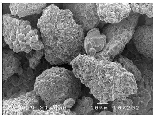
Figura 6-22 Superficie libre del polvo de TiO 2 XPT-DH-1102 (MEB x1000)
