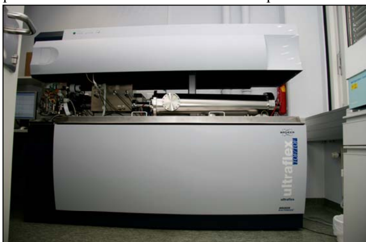
Figura 83. Espectrofotómetro MALDI-TOF utilizado para la identificación proteica.
