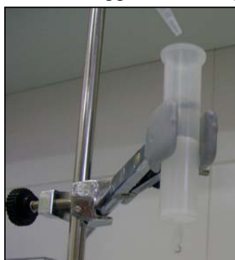
Figura 20. Diálisis del anticuerpo utilizando una Columna NAP-10 (Amersham Biosciences; Uppsala, Suecia).
