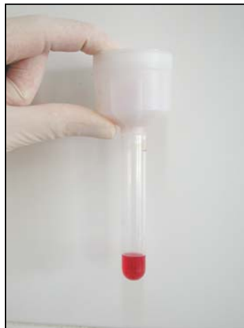
Figura 25. El jugo cárnico en el fondo de un colector de extracto cárnico tras ser congelado y descongelado.
