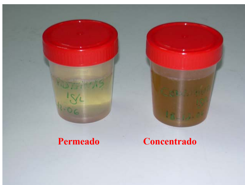
Figura 68. Comparación visual del rechazo de proteínas por parte de la membrana de nanofiltración MPS-36 (Koch, EE.UU.)
