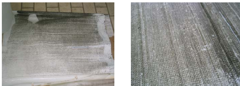
Figura 90. Depósitos de sólidos sobre la membrana de nanofiltración
