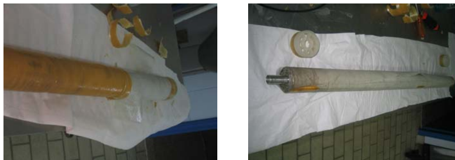
Figura 88. Retirada de la carcasa de la membrana
