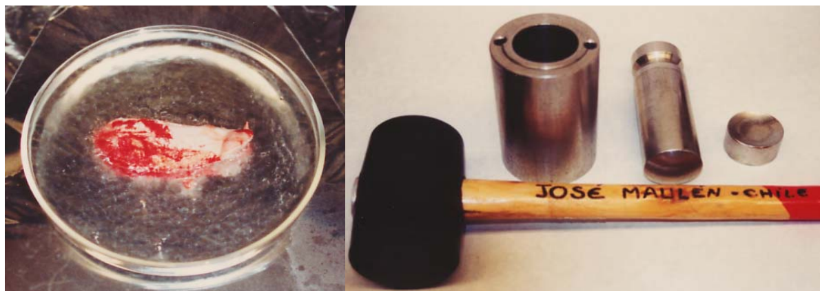
Figura 2.6.-Se muestra el músculo congelado, el mortero de acero y el mazo para pulverizarlo.
