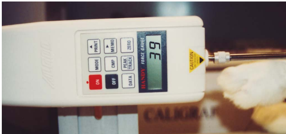
Figura 2.10.-Detalle del transductor de tensión.
