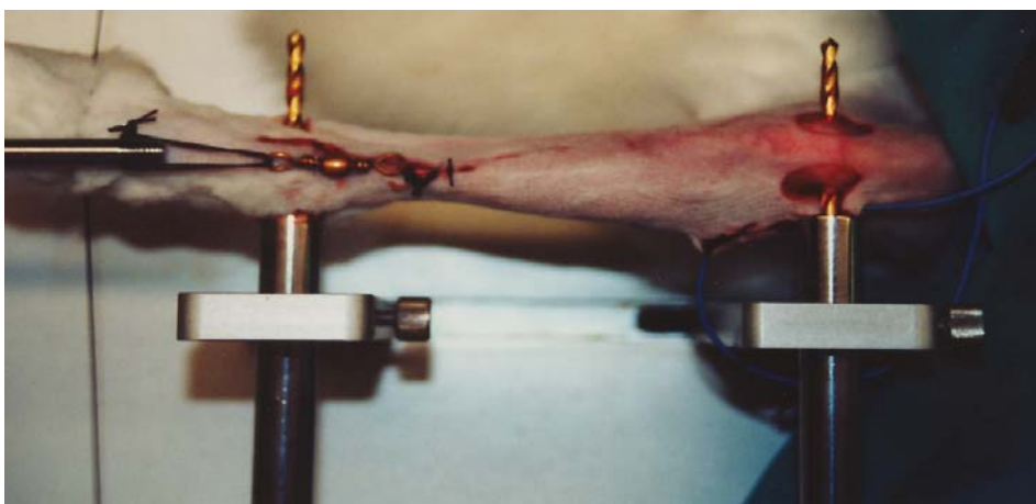
Figura 2.9.- Fijación de la extremidad a la mesa de registro y amarre al transductor de tensión.
