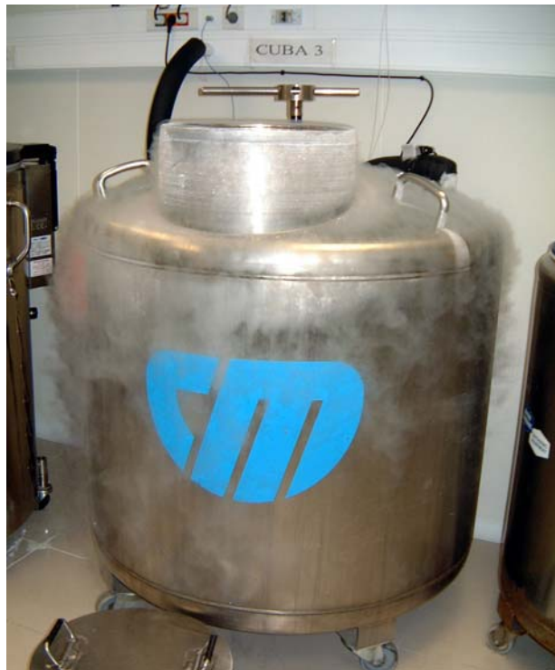
Fig. 16. Cubes de nitrogen líquid on poden estar les mostres per llargs períodes de temps.
