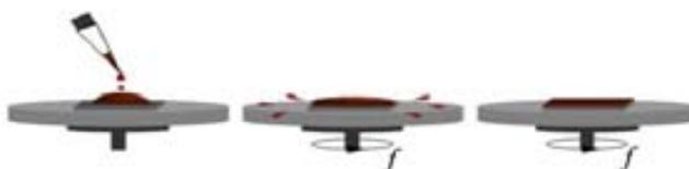
Fig. 2.4. Representación esquemática de la deposición de capas delgadas por el método de recubrimiento por rotación (en inglés, “spin coating”). En nuestro caso se depositan  $15 \mu l$  de la solución metal-orgánica sobre un sustrato.
