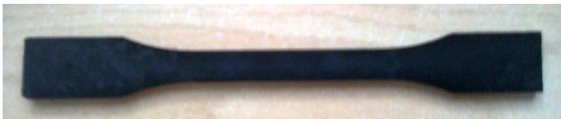
Figura 1.4 - Probeta de PA66-GF50 usada en MUE
