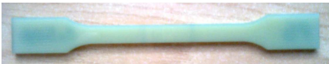
Figura 1.2 - Probeta de PA66 usada en MUE
