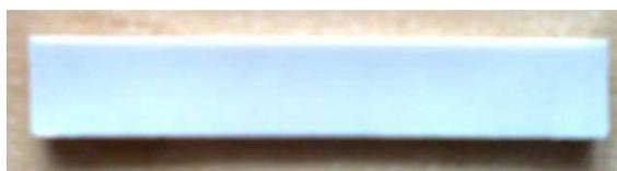
Figura 1.5 - Probeta de PA6-MD40 usada en DMA
