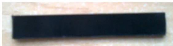
Figura 1.3 - Probeta de PA66-GF50 usada en DMA
