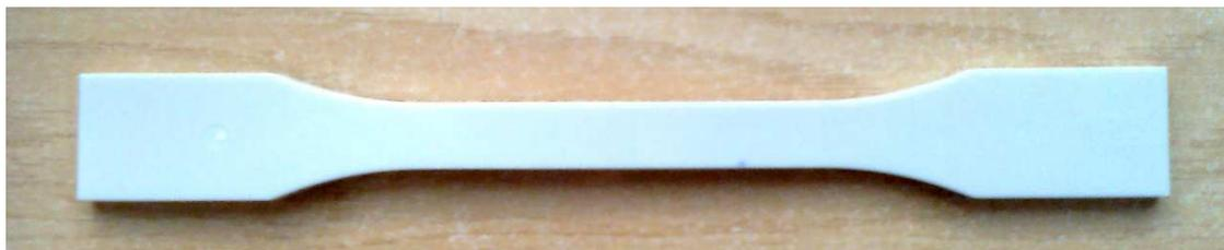
Figura 1.6 - Probeta de PA6-MD40 usada en MUE
