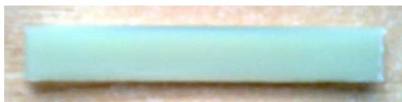
Figura 1.1 - Probeta de PA66 usada en DMA
