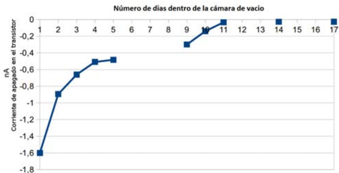
Figura 81 Resultado para el análisis de la relación entre la corriente de apagado del OTFT con la exposición al aire.
