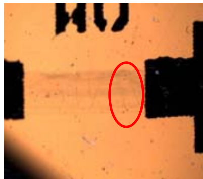
Figura 21 Rupturas de la capa de material resistivo.
