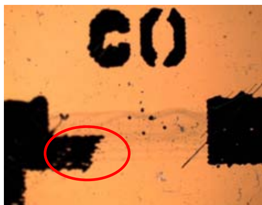
Figura 25 Fallo de arrastre de una parte del contacto.
