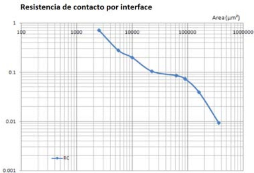
Figura 28 Medición de la resistencia de contacto de interface y área de contacto para dos interfaces de metal diferentes. Para estructuras impresas con Inkjet.
