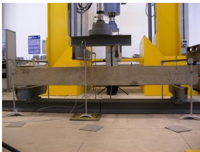
Figura 5.1.3.2. Configuración del ensayo con los LVDTs.
