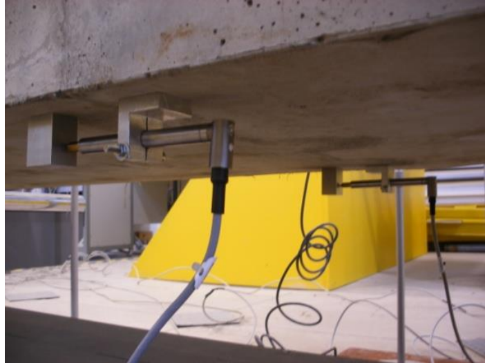
Figura 5.1.3.3. LVDTs para medir la apertura de fisura entre las caras de las fases de hormigonado de la junta
