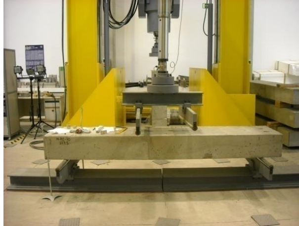
Figura 5.1.4.1. Detalle de la colocación de una de las vigas para el ensayo.
