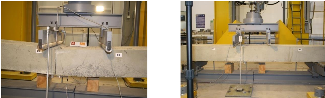
Figura 5.1.4.2. Colocación de los LVDTs en la losa.
