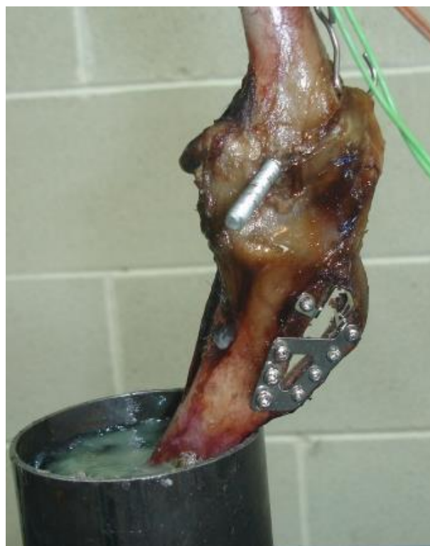
Figura 35. Vista de la placa patentada pels Drs. Durall i Díaz-Bertrana per al tractament de trencament del LCA, utilitzada durant els assajos. La placa té un braç cranial i caudal amb orificis, ambdós units per la seva base i per un braç proximal.
