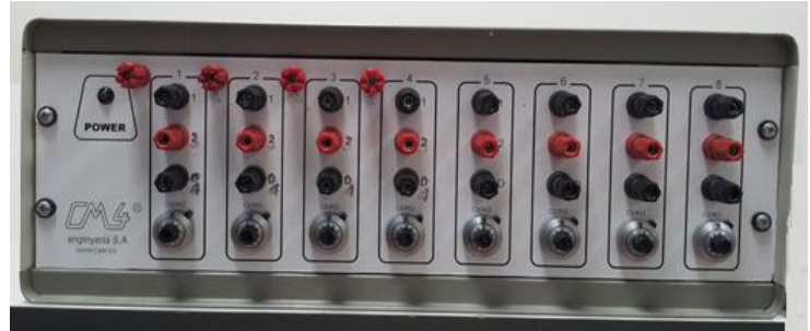
Figura 33. Els 8 canals del multiplexor amb les connexions del pont de Wheatstone de cada canal.
