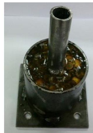
Figura 15. La resina és “Araldite Ràpid Ceys”, un adhesiu epoxídic denominat estructural per la seva capacitat d'absorbir alts esforços mecànics. Resisteix temperatures entre -60 i +65°C i traccions de fins a 32 MPa. La càrrega metàl·lica està formada per peces cilíndriques de llautó de 11 mm de diàmetre i 3 mm d'espessor.
