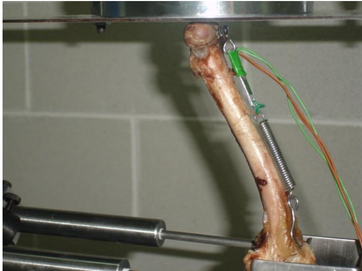
Figura 22. Simulació de la musculatura extensora amb molla elàstica (de força coneguda), col·locada paral·lela al fèmur. S'insereix a la part proximal del fèmur amb cargol roscat i per l'altre extrem, a la patel·la, prèviament trepada, amb un ganxo.
