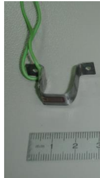
Figura 28. Captador en forma d'omega per a mesurar elongacions al LCP (dreta). La galga treballa a flexió: si les extremitats de l'omega s'allunyen la galga treballa a tracció, la deformació és similar a la que pateix una biga sotmesa a flexió (figura esquerra, les fletxes vermelles indiquen les fibres que es troben a tracció i a compressió). Si les extremitats de l'omega s'apropen la deformació és a la inversa i la galga es comprimeix.
