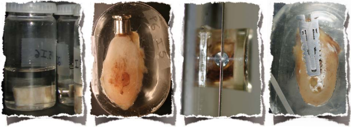
Fig. 3.3. Procesado de las muestras: a) Deshidratación, b) Inclusión en resina, c) Sección en el eje longitudinal medial del implante, d) Pulido.
