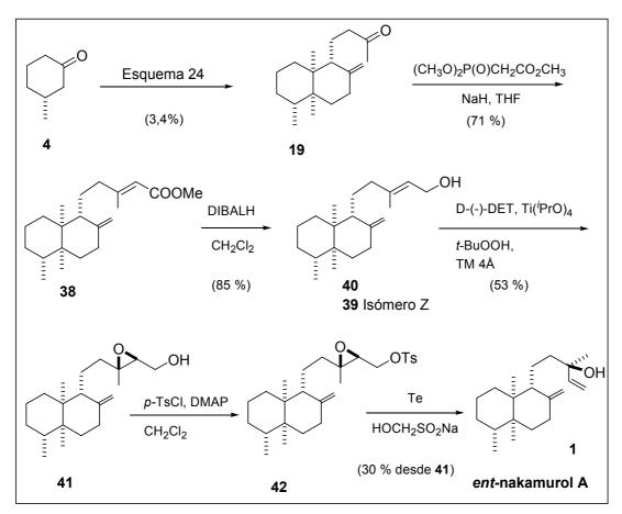
Esquema 25. Segunda síntesis del ent-nakamurol A
