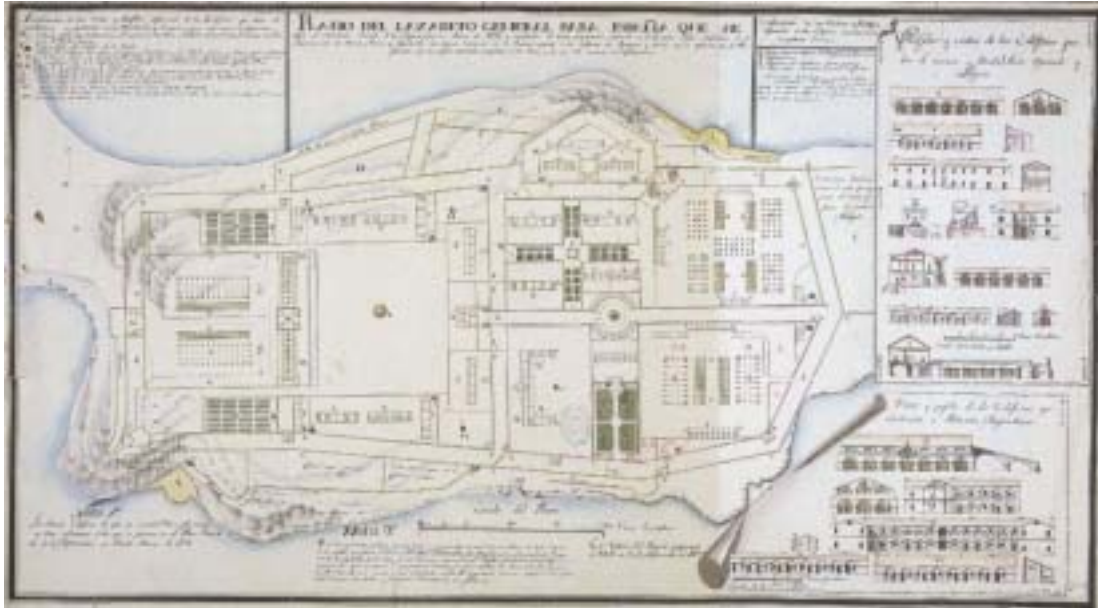
Figura 9.4 Plano del lazareto general para España, planta y alzado, por Manuel Pueyo, 1795 (SHM, 3588-17)
