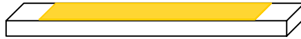
Figura 3.7. Film de PHA de 0,1-0,15 mm de gruix dipositat sobre un suport de vidre.
