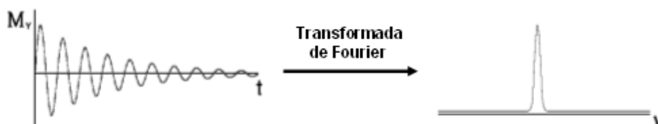
Figura 3.17. Efecte de la transformada de Fourier. A l'esquerra es mostra el senyal FID on es té una representació del moment magnètic ( M_v ) en el domini de temps. A la dreta es mostra el resultat de la transformada de Fourier d'aquest FID en el qual es té l'amplitud del senyal en el domini de freqüències.
