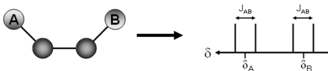
Figura 3.16. Exemple de desdoblatment del senyal en presència de dos spins.
