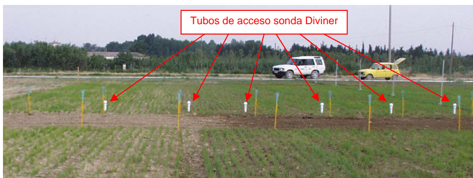
Figura V.3. Tubos de acceso para la medida de la humedad del suelo con la sonda FDR Diviner 2000 en el año 2002, en la variedad Guadiamar. De izquierda a derecha, los tubos corresponden a los tratamientos de riego T6S, T5S, T4S, T3S, T2S y T1S.
