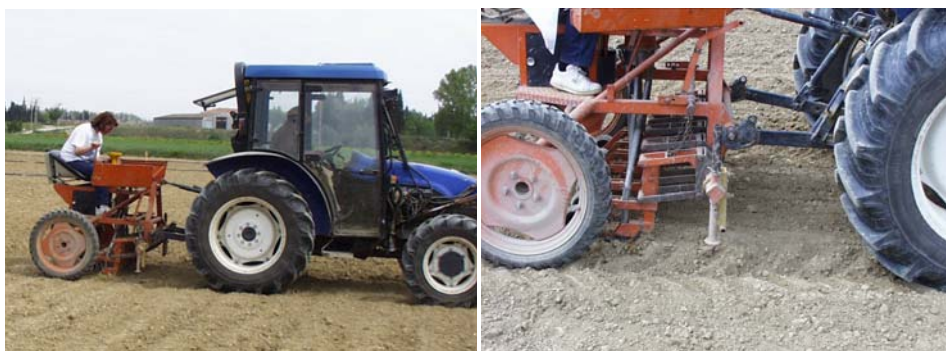
Figura IV.1. Imágenes de la sembradora de ensayos tipo Øyjord (Wintersteiger, Ried, Austria).
