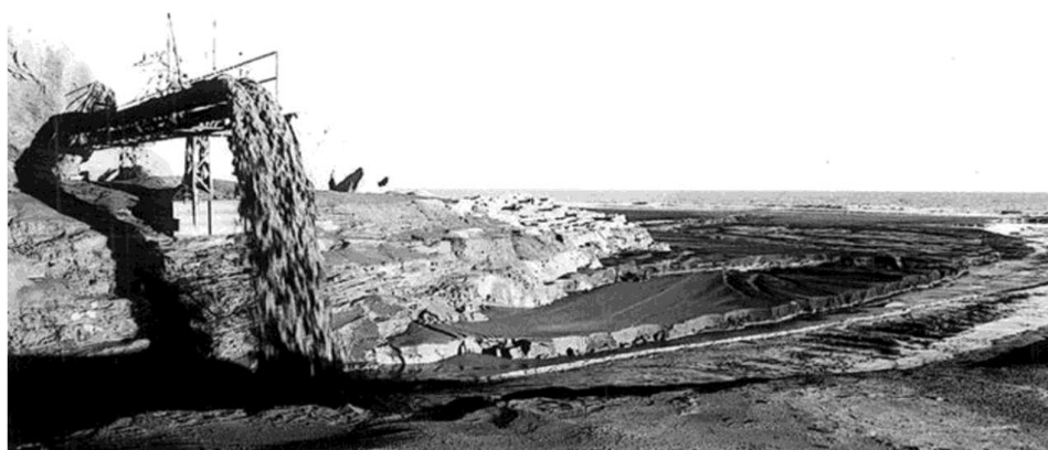
Figura 3. 5.- Tubería de descarga de residuos del lavadero. Imagen procedente de (La Verdad, 2013).
