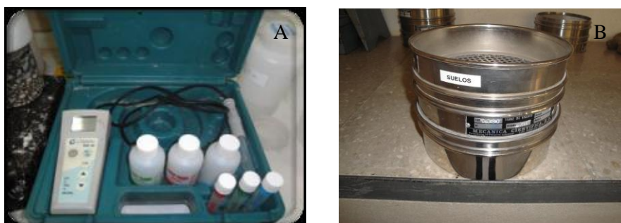
Figura 3. 12.- A) Medidor de pH y conductividad eléctrica y B) Tamiz de 2mm de luz de malla.
