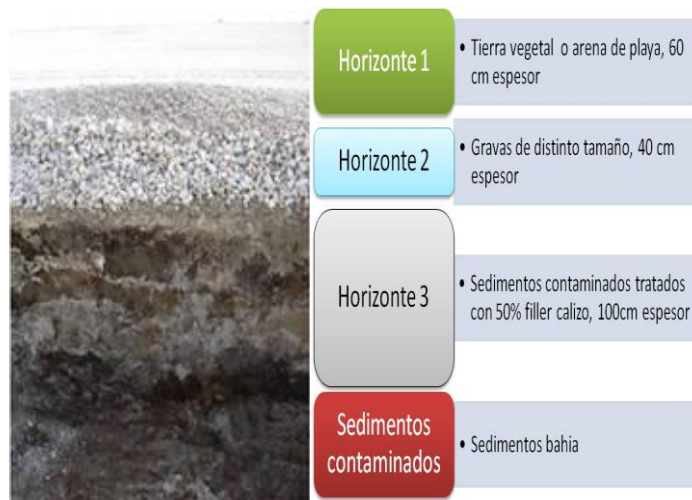
Figura 1. 6.- Diferentes capas de tratamiento del Tecnosol piloto.
