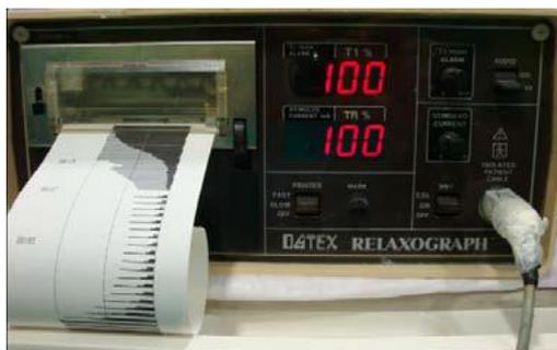
Figura 16. Electromiógrafo. *Relaxograph NMT (Datex Instrumentarium Oy, Helsinki, Finlandia)*. Se observa el registro en tiempo real del TOF.
