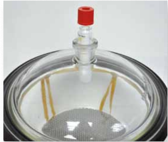
Figura 3.2: Detalle de la tapa del desecador con el papel de filtro enroscado, en el que se dosificaban los \mu L de BV correspondientes.
