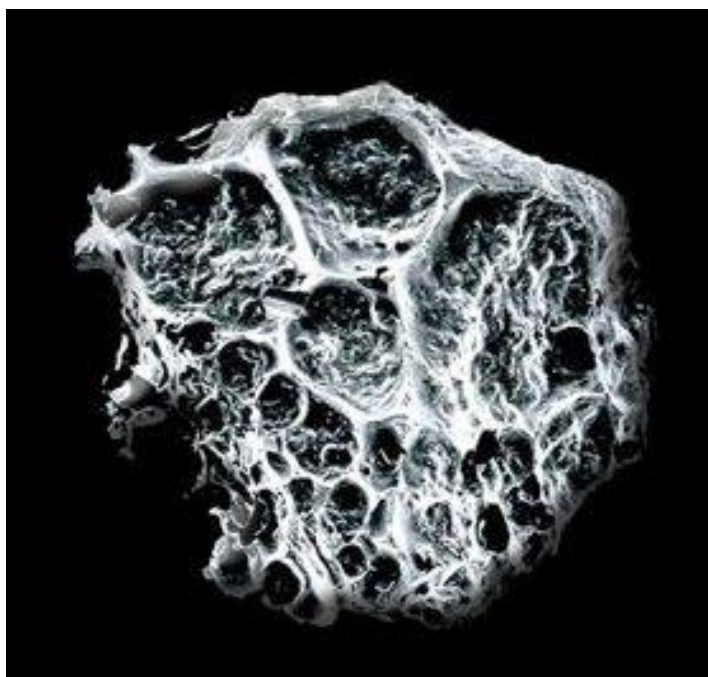
Figura 7.- Grano polvo de carbón activado visto al microscopio y en el que se observa su extrema porosidad, que le da su gran capacidad adsorptiva.
