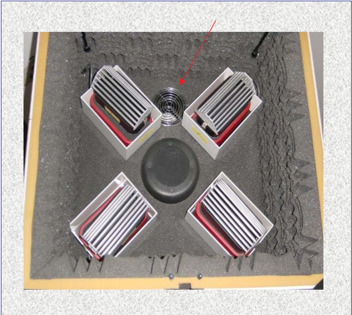
Fig. 12. Animal Acoustic Startle System. Detalle del interior de una caja de insonorización. Se observa centrado el altavoz que emite ruidos (el de tonos se halla en la tapa superior no visible en la foto), está rodeado de 4 plataformas-sensores- con jaulas para ratas. En la zona superior de la imagen se observa la rejilla del ventilador que emite un ruido de fondo continuo y regular (background noise) durante todo el experimento.
