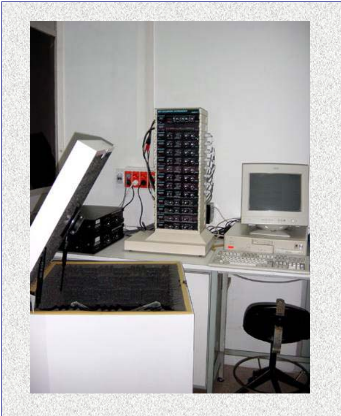
Fig. 11. Animal Acoustic Startle System. Cámara de insonorización en el que sea hallan las sensoras y los altavoces. En la poyata, de izquierda a derecha: los amplificadores, la torreta de control del tipo de ondas emitidas-recibidas, ordenador en el que se programan los trial y digitaliza la señal de respuesta.
