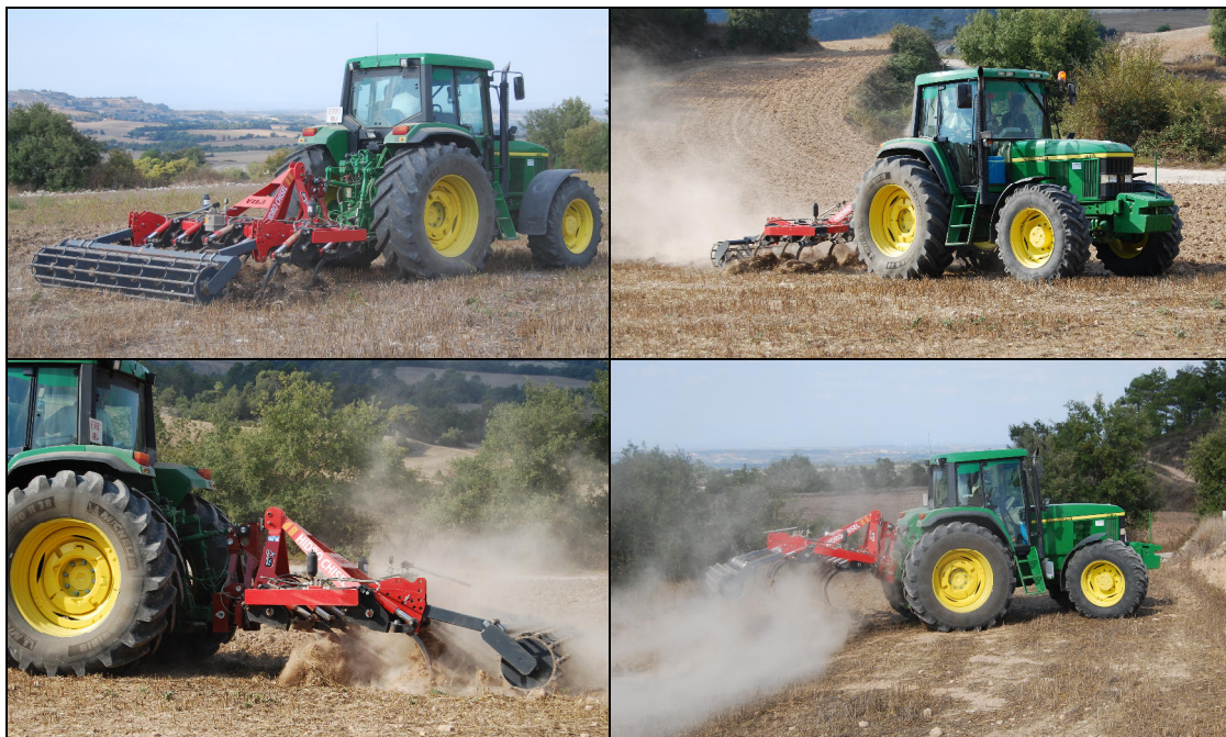
Figura 13.1: Imatges de l'assaig amb cultivador de cisells
