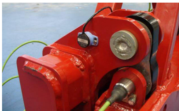
Figura 12.3: Inclinòmetre per a la mesura del capcineig del dinamòmetre tripuntal
