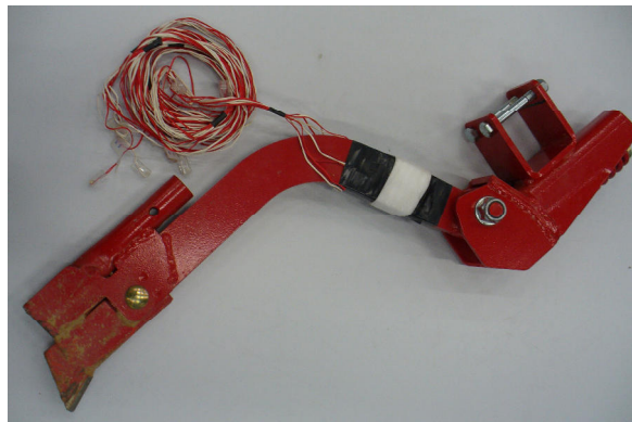
Figura 13.12: Rella instrumentada amb galgues extensomètriques
