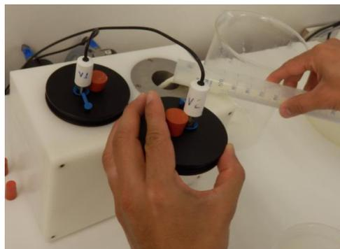
**Figura 9.1** Adición de la muestra en el sensor de dispersión de luz con electrodos de pH.
