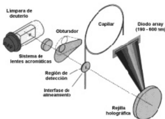
**Figura 2.6.** Detección en CE mediante un detector de diodos en línea
