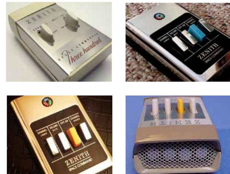
Ilustración 6 - Diversos modelos del mando a distancia Zenith Space Command, permitía cambiar el canal y el volumen mediante ultrasonidos. Fuente: Push Click Touch. (4 de diciembre de 2007). Recuperado el 28 de junio de 2015, de <http://www.pushclicktouch.com/blog/?mobile=0&paged=6>
