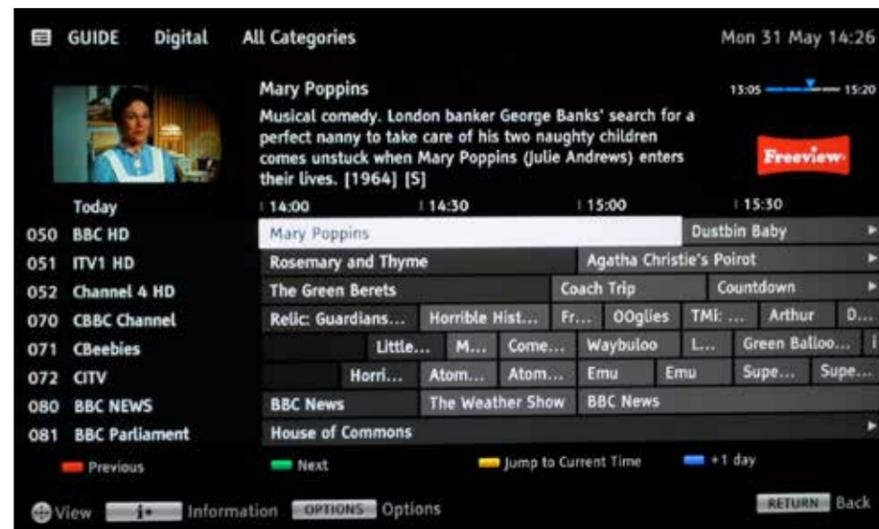
Ilustración 40 – Servicio de EPG que incorpora el acceso a los diferentes canales, programación por horas y función *picture-in-picture* donde se ve la imagen de la emisión en curso.
