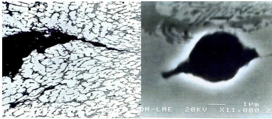
Figura 127. Imágenes SEM de las muestras deformadas: a) 700^{\circ}\text{C} y 1 \text{ E-1 s}^{-1} y b) 750^{\circ}\text{C} y 1 \text{ E-1 s}^{-1}
