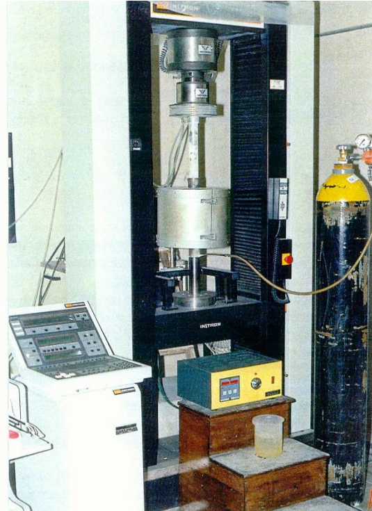
Figura 19. Montaje del equipo de ensayo de compresión uniaxial.
