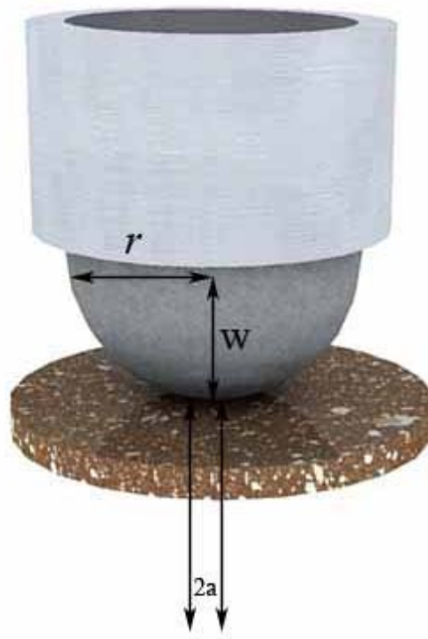
Figura 30. Model d'un espècimen en el test de resistència a la fractura Hertziana. W : força aplicada; r : radi de l'esfera (mm).
