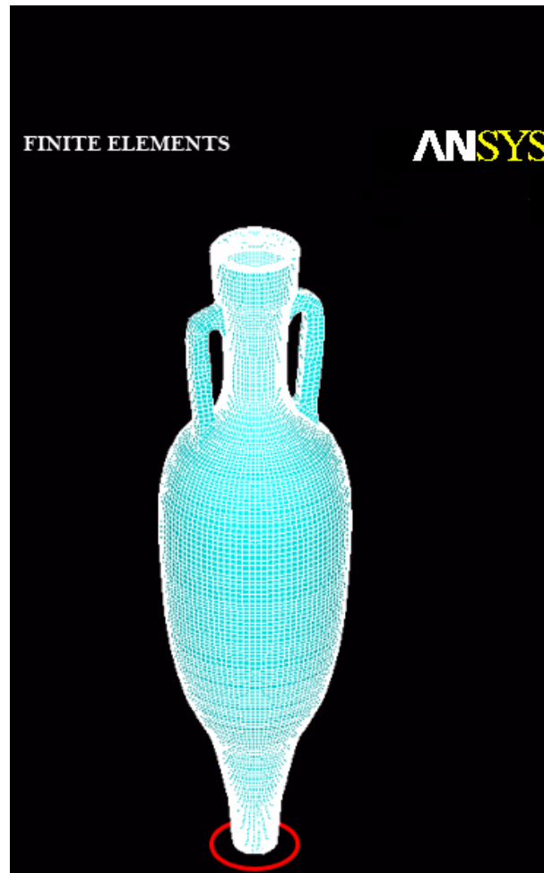
Figura 156. Simulació de l'aplicació de forces als quatre models d'àmfores.
