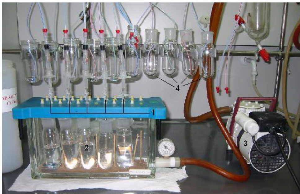
Figura 2. 20. Muntatge del sistema de fraccionament per carbons: Tubs de carbó (1), cubeta de buit (2), bomba de buit (3), recipients per la fase mòbil (4)
