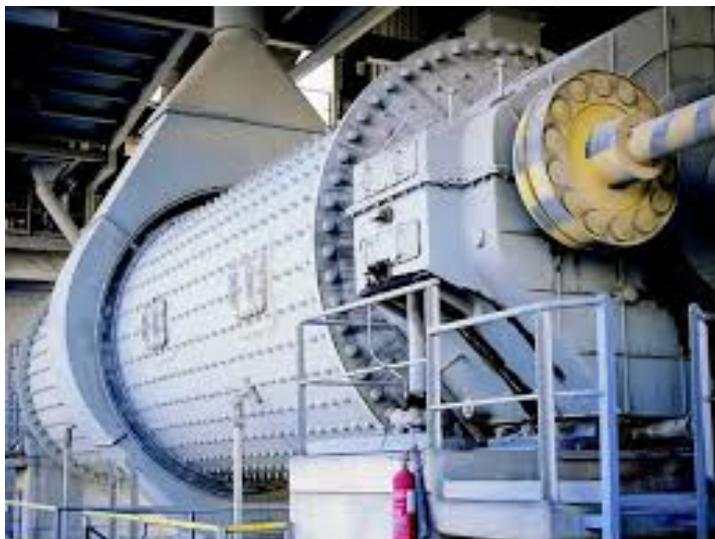
Fig. 53.-Molino de cemento horizontal
