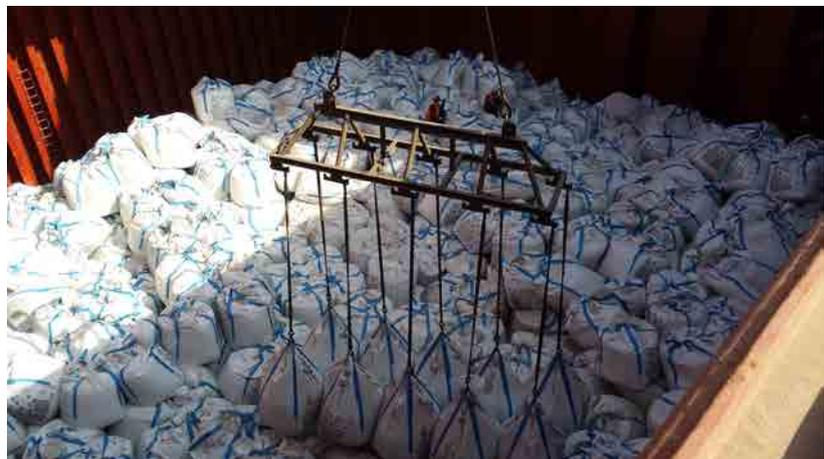
Fig. 73.-Carga de cemento en Big Bags
