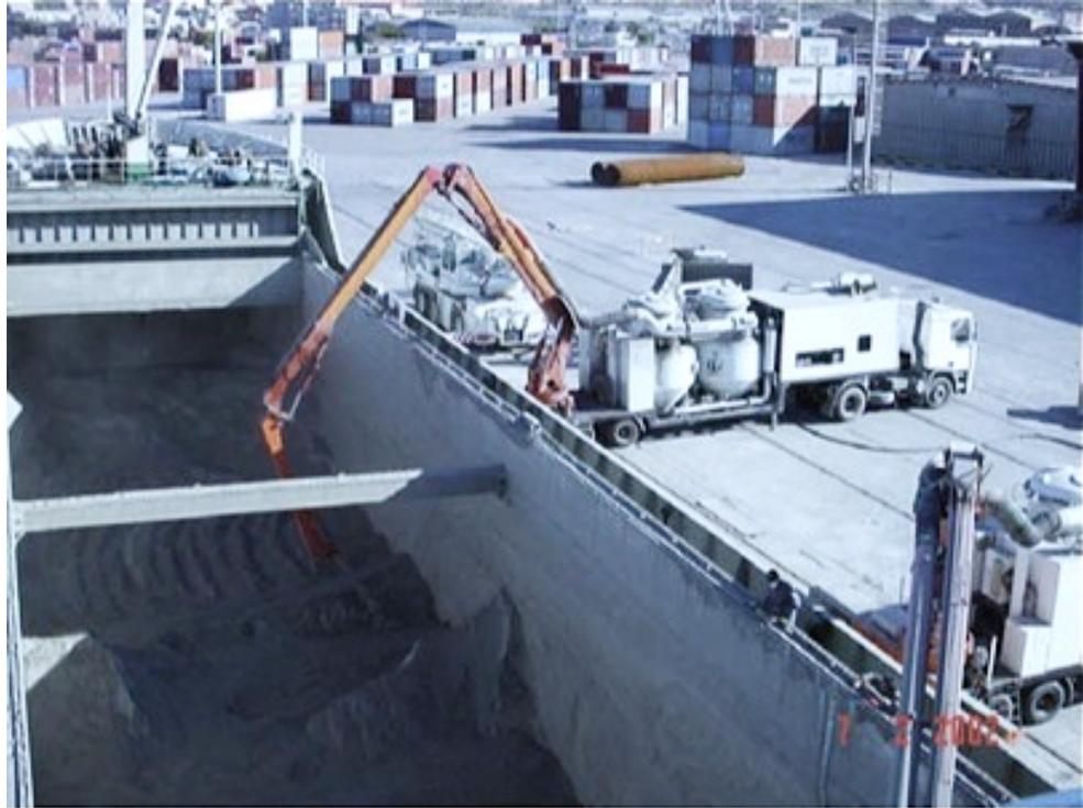
Fig. 51.-Descarga de cemento mediante sistema Kovaco en el puerto de Alicante
