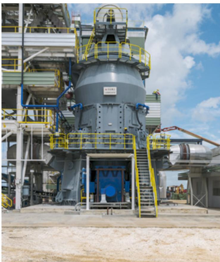
Fig. 54.-Molino de cemento vertical
