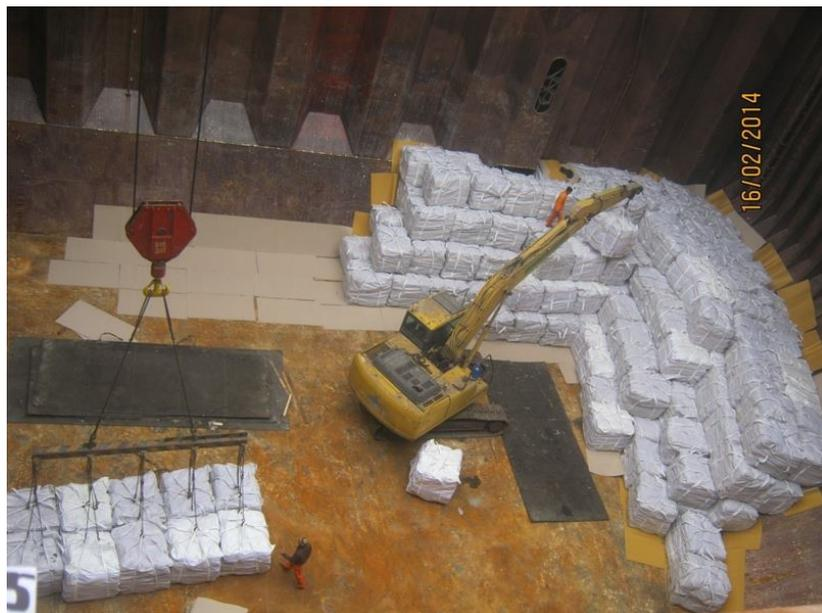
Fig. 72.-Carga de cemento en Sling Bags
