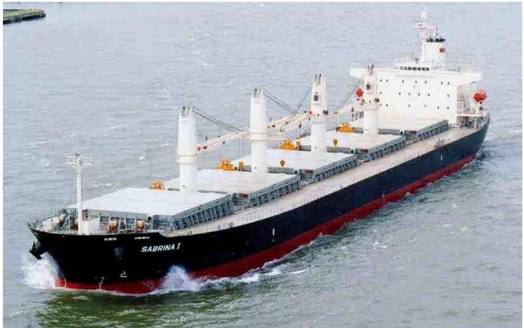
Fig. 63.-Granelero tipo “Handymax”
