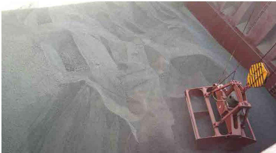
Fig. 74.-Descarga de Clinker
