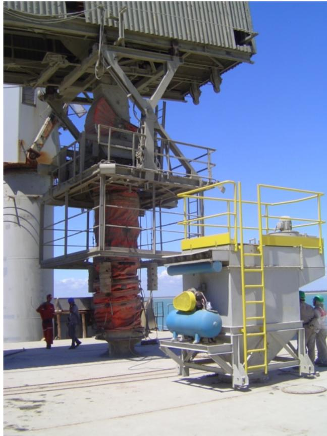
Fig. 68: Ver brazo cargador a la izquierda. y filtro a la derecha
