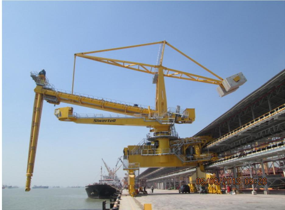
Fig. 52.-Máquina Siwertell y cinta transportadora a la derecha
