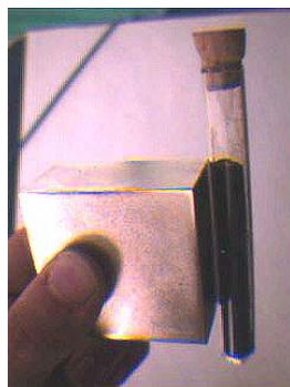
Figura 10: Aerogel nanocomposat amb Fe, que mostra propietats magnètiques.
