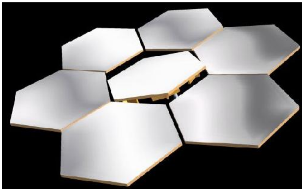
Figura 6.4 Detall de desalineament angular dels miralls ( tip & tilt )
