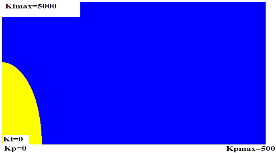
Figura 6.16 Regió admissible dels paràmetres del controlador k_p i k_i en la planta de l'interferòmetre
