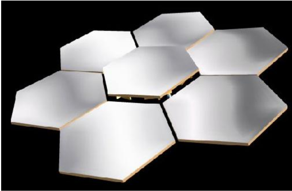
Figura 6.5 Detall de desalineament lineal dels miralls ( pistö )
