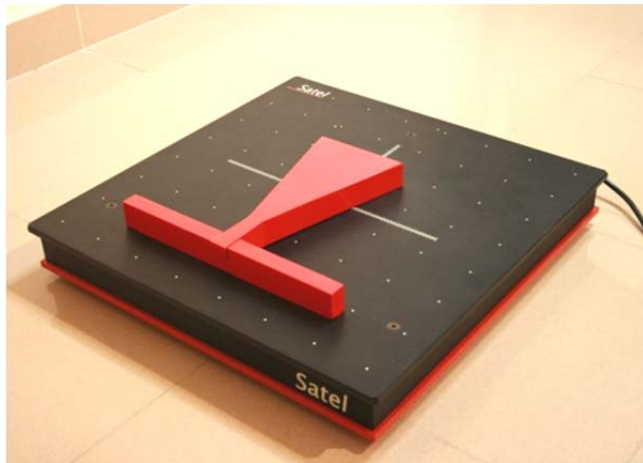
Figura 18. Plataforma de estabilometría Satel.
