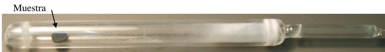
Fig. 33 – Capsula de cuarzo al vacío con muestra de  $\text{Eu}_2\text{Ru}_2\text{O}_7$  dentro.
