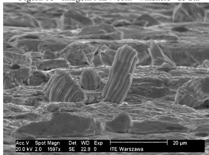
Figura 18 - Imagem MEV com “whiskers” de Sn.
