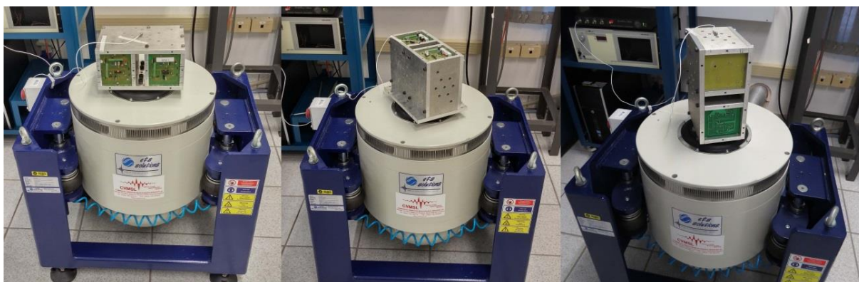
Figura 88 - Teste de vibração em operação nos sentidos longitudinal, transversal e vertical.
