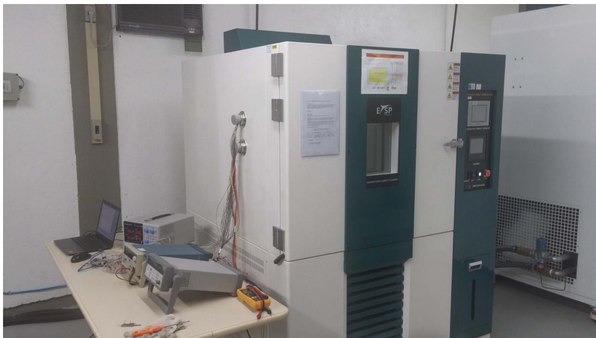
Figura 57 - Equipamento de ciclagem térmica.
