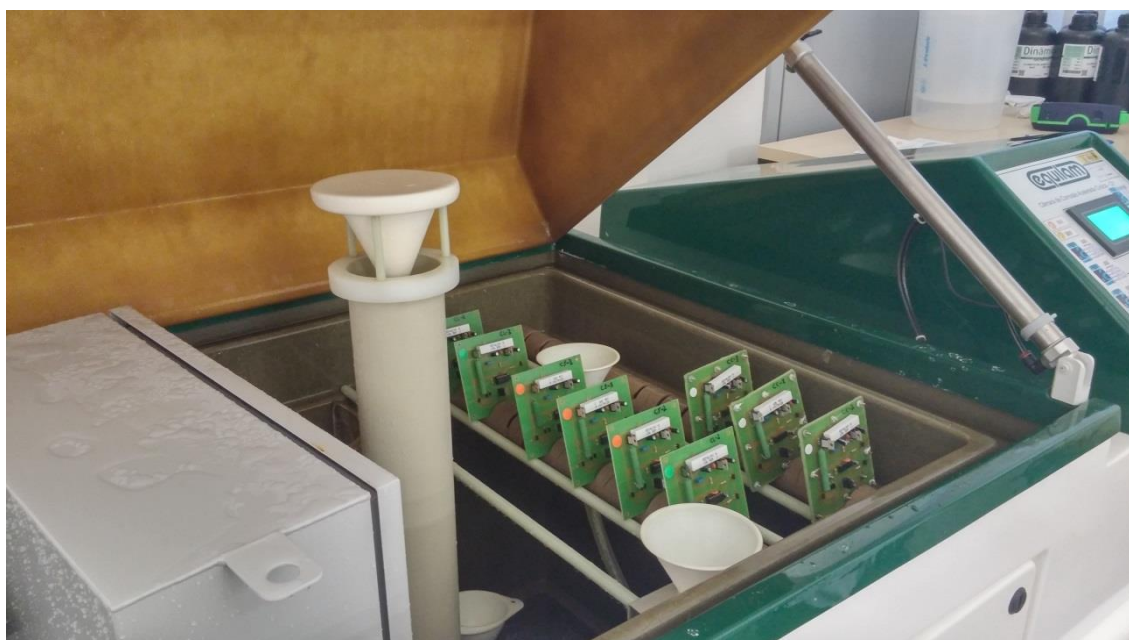
Figura 93 - Equipamento de névoa salina.
