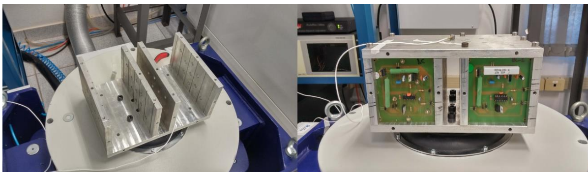
Figura 59 - Montagem do suporte para o teste de vibração no equipamento.
