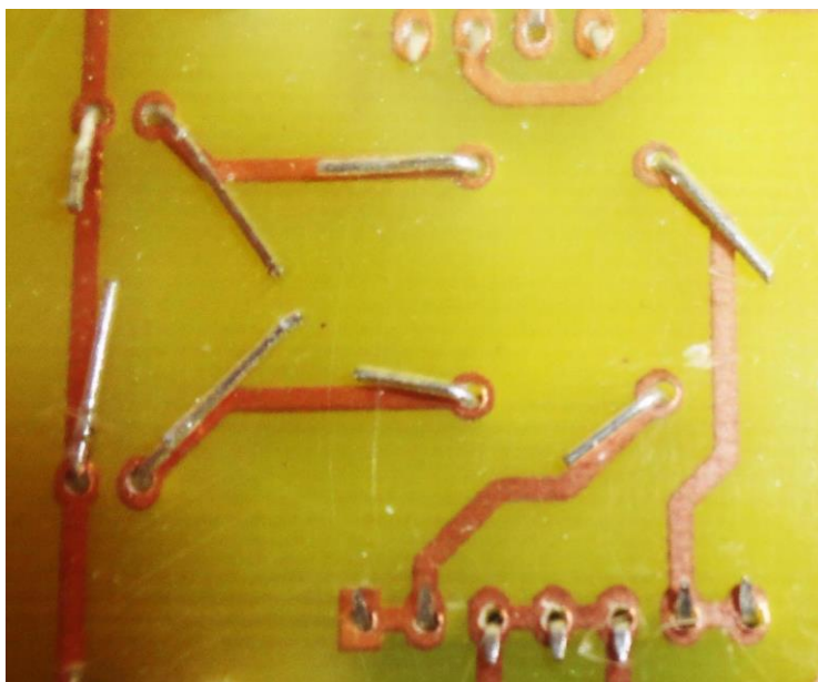
Figura 68 - Imagem das trilhas de cobre e das uniões realizadas com pressão.
