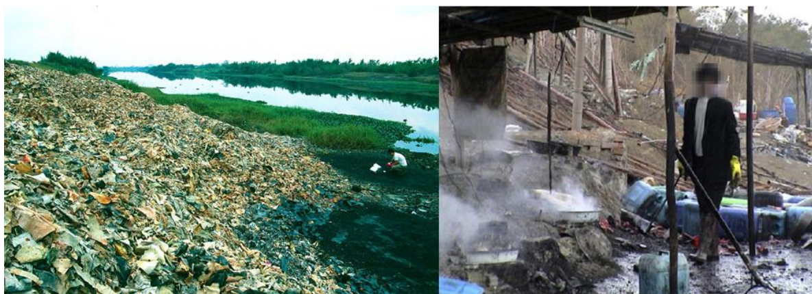
Figura 13 - A) Despejo de placas de circuito tratadas com ácido e resíduos de processamento ao longo do rio Lianjiang na China. B) Recuperação de ouro a partir dos resíduos de PCI usando banhos ácidos.
