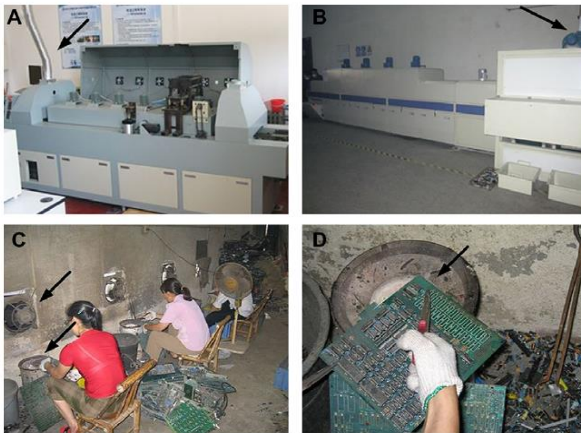
Figura 20 - Uma máquina semi-automática de desmontagem (A e B) e um aquecedor simples utilizando métodos primitivos (C e D).
