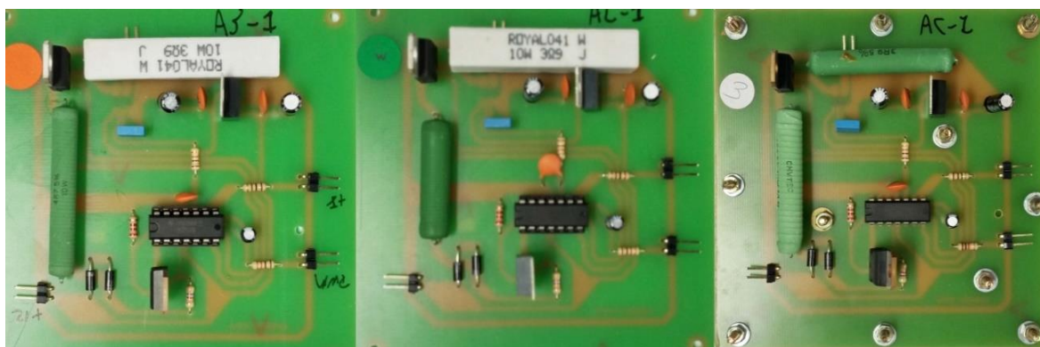
Figura 52 - Placas corrente usadas para o teste de ciclagem térmica.
