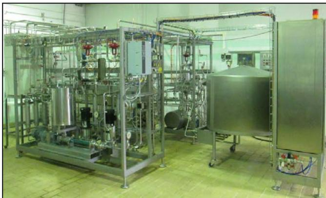
**Figura 4.1.1.** Equipo de tratamiento térmico en continuo Tetra Therm ® Aseptic Pilot utilizado en los experimentos.
