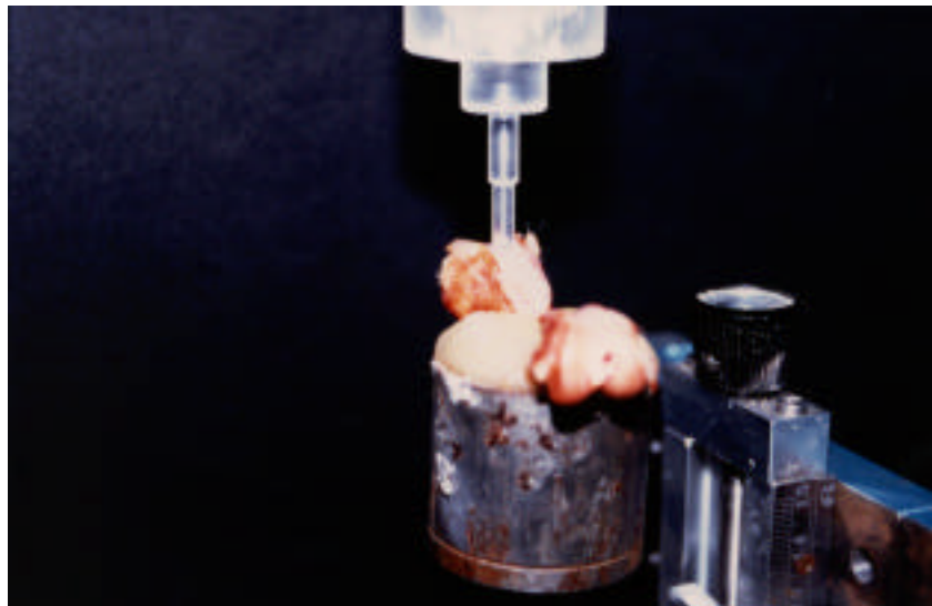
Figura 21: Especímenes colocados sobre la cubeta del aparato de indentación.
