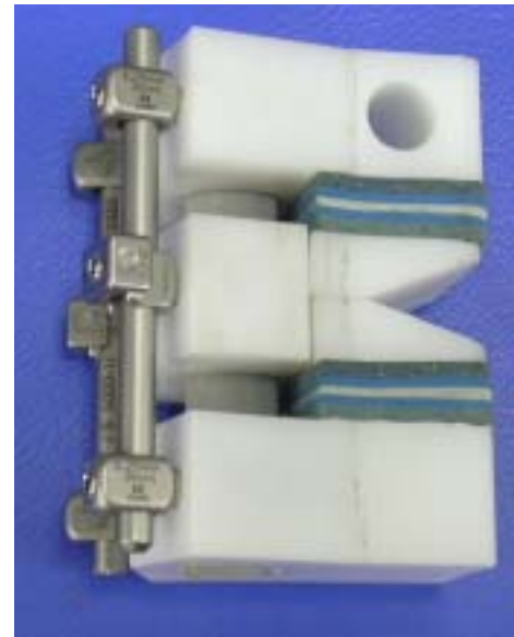
Figura 89. Configuración de de 6T con vértebra fracturada instrumentada para los ensayos de rigidez, resistencia y fatiga a flexo-compresión.
