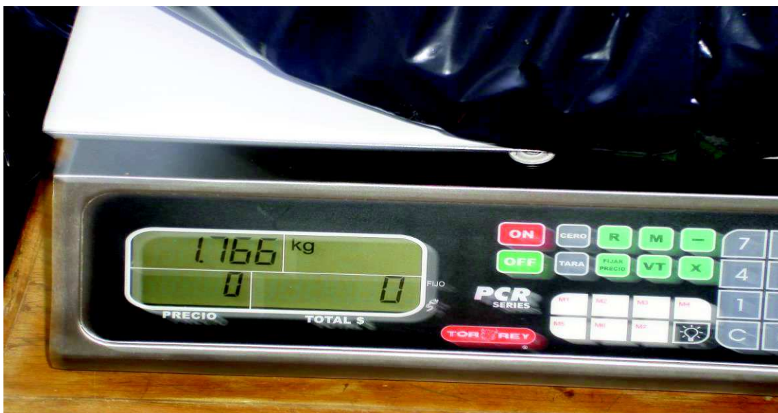
Fotografía 4.3 Báscula digital utilizada para pesar los RSU
