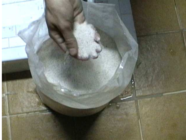
Figura 1.12. Arena utilizada para la filtración del agua gris.
