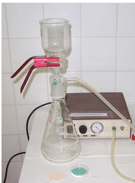
Figura 2.1. Material utilizado para el análisis microbiológico: (a) sistema de filtración; (b) membrana, disco de cartón nutriente y placa de cultivo con colonias.
