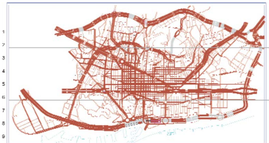
Figura 3-1. Este plano muestra la intensidad de vehículos que pasan directamente por la red viaria de la ciudad. Para confeccionarlo se realizan periódicamente recuentos, automáticos y manuales, del número de coches que pasan por una vía durante todo el día; este cálculo permite obtener la Intensidad Media Diaria (índice IMD), que es un indicador fundamental para la elaboración de la Red Básica. Las vías marcadas con un grosor superior muestran una intensidad de tráfico más elevada y se corresponden con las vías de jerarquía superior de la Red Básica de la ciudad (Ajuntament de Barcelona, 2009).
