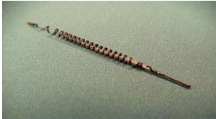
Foto 6. Dispositivo expandido, libre del catéter guía. En el interior de la doble hélice se observan las fibras de Dacron.
