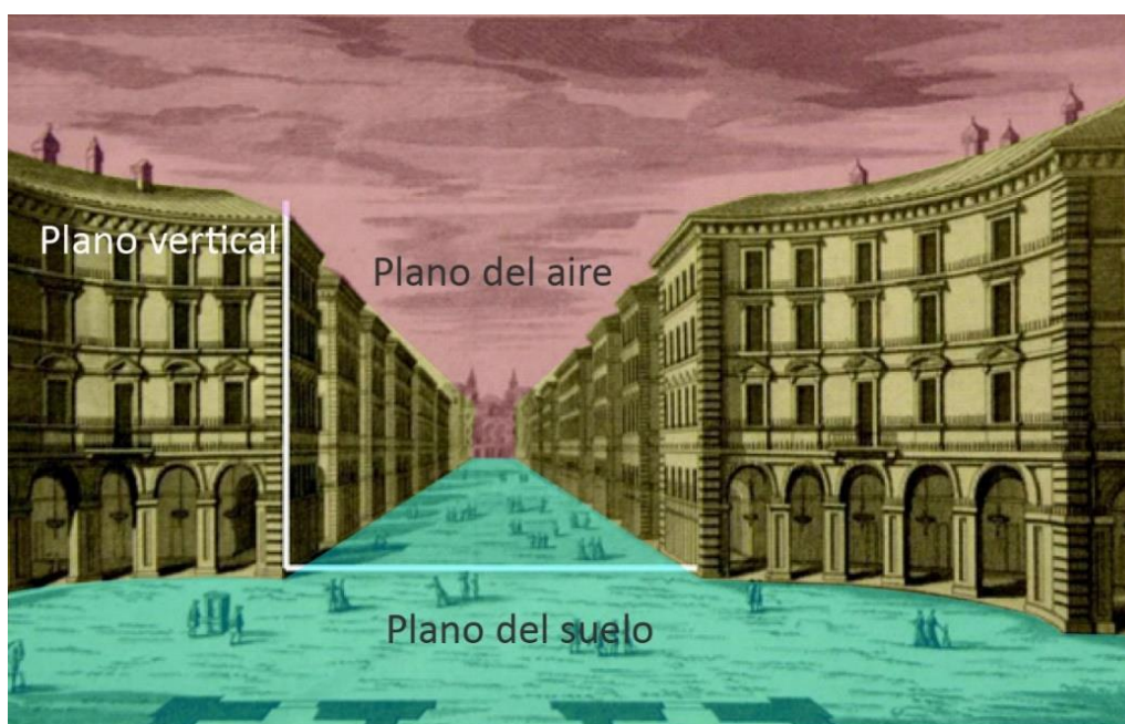
Fig.164.El grabado representa las modificaciones que Filippo Juvara introduce en Turín, basándose en los criterios figurativos de trazado a cordel y alineación; relación anchura calle-altura edificado; control figurativo de las fachadas. Estos principios serían importantes en buena parte de la conformación de la ciudad barroca y continuarían en la conformación de la ciudad industrial (Sabaté, Joaquim 1999) y el reclamo de los movimientos del Arte Cívico o del Public Art (Remesar, A 2016; Hegemann, Werner - Peets, Elbert 1992; Moughtin, C - Oc, T - Tiesdell, S 1999; Olsen, Donald J. 1986). En el grabado podemos identificar claramente los tres planos a los que nos referimos.
