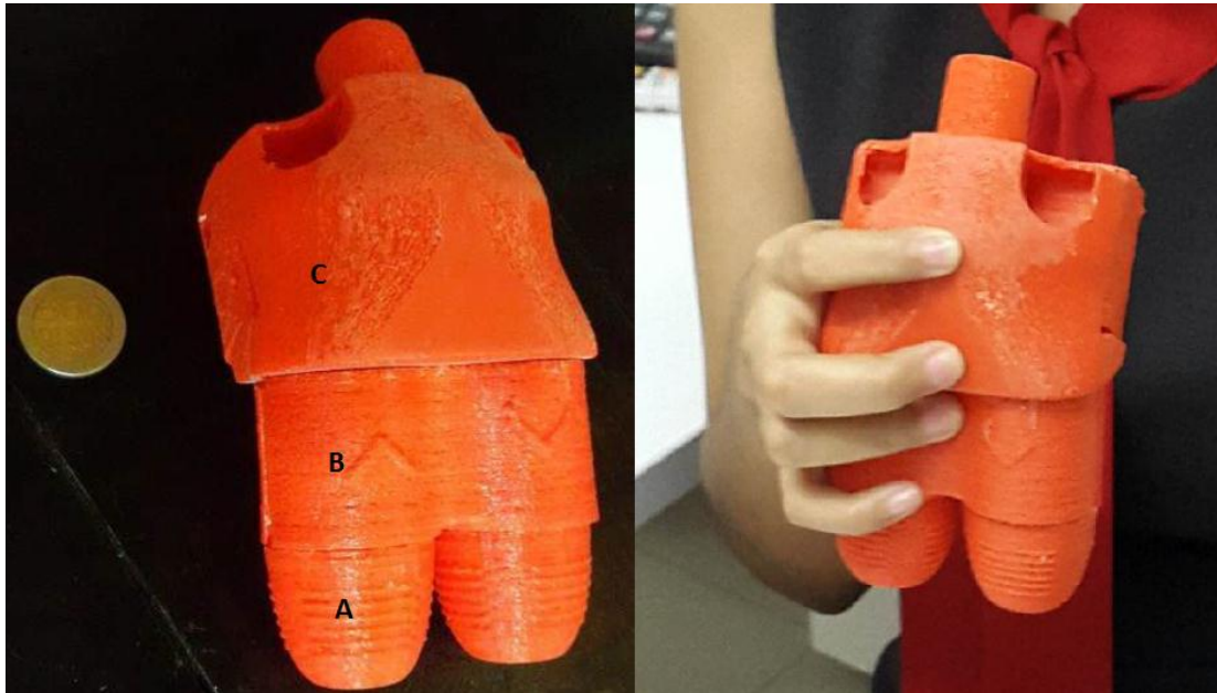
Figura 5. Primer prototipo de la Válvula Excelsior con sus 3 componentes principales. A. Válvula dual. B. Cámara de mezcla. C. Carcasa de componentes electrónicos. (Cáceres et al, Memoria de Tesis Doctoral, 2016).
