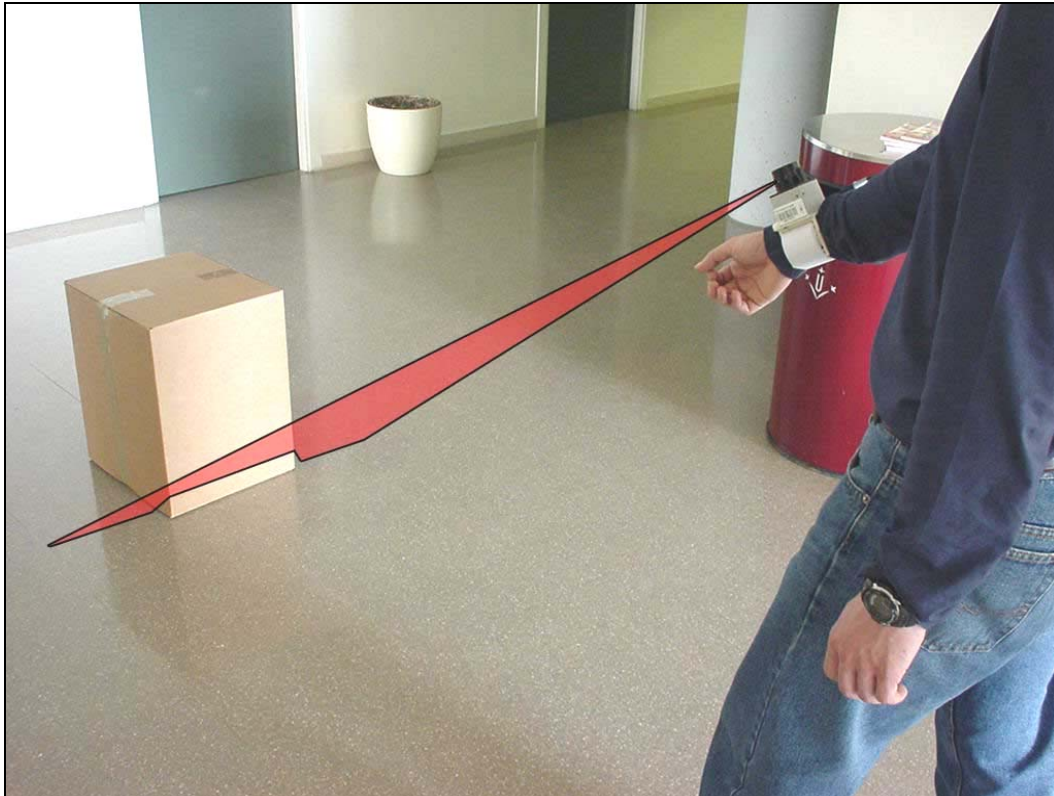
Fig. 6.2: Sistema operando en modo detección de obstáculos, el brazo del usuario está inclinado respecto al horizonte unos 45^\circ .
