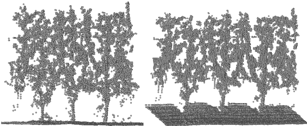
Fig. 4.3: Reconstrucción tridimensional de una exploración realizada en condiciones ideales (izquierda) y con un error de inclinación simulado (derecha).
