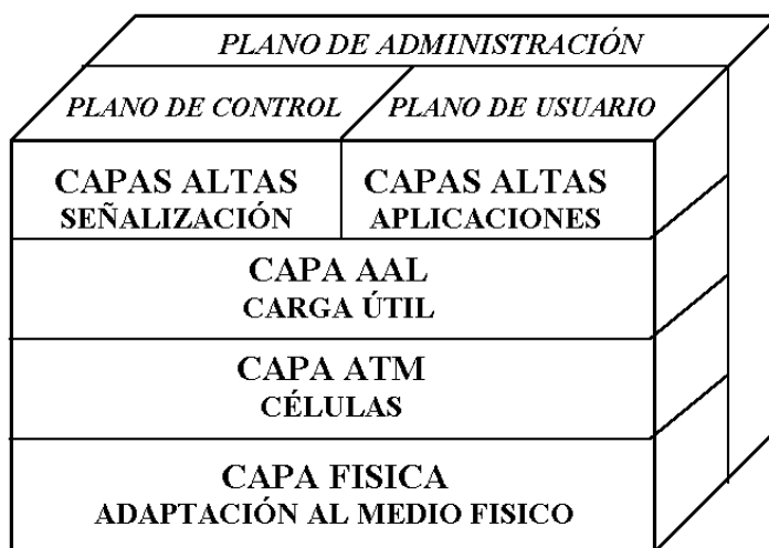
Fig. 3.1: Arquitectura del protocolo ATM
