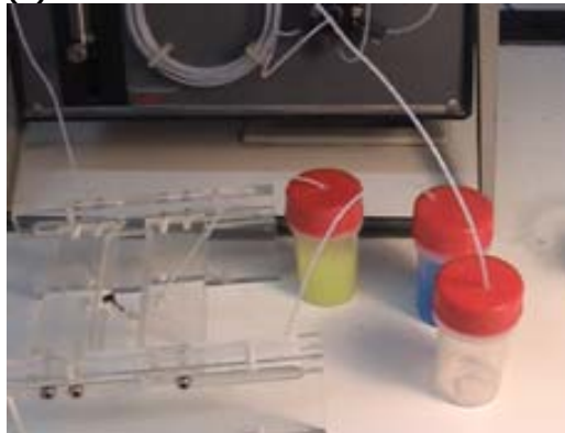
Figura 5.5: Imágenes ópticas de (a) el montaje experimental mostrando la conexión entre el chip, la microbureta y las tintas de colores y (b) detalle del experimento realizado con el micromezclador.
