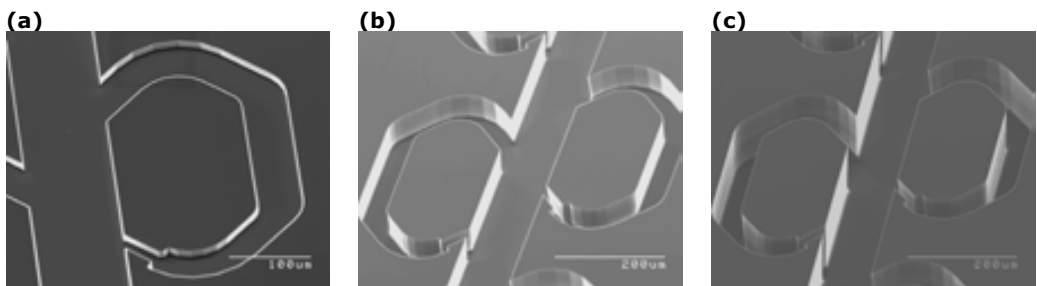
Figura 5.15: Imágenes SEM de los micromezcladores fabricados con una profundidad de (a) 10, (b) 50 y (c) 100 \mu\text{m} .
