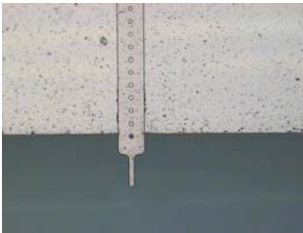
Figura 3.14: Aspecto de una punta de una micro/nanopipeta después del serrado de la oblea sin resina de protección.
