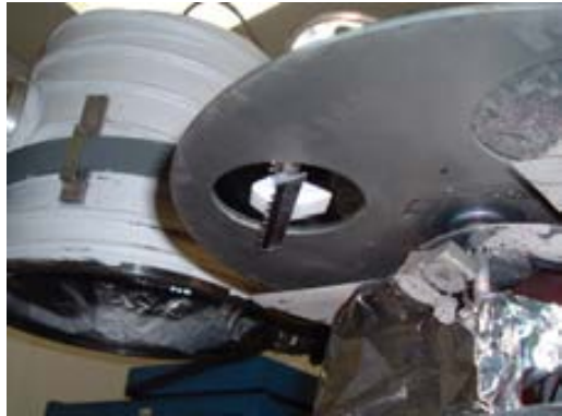
Figura D.1: Imágenes del montaje utilizado para la deposición de la capa semilla, (a) distribución de los chips en la oblea sobre el soporte para evitar que entre la capa semilla en la cavidad de entrada y (b) posición final en el equipo de deposición perteneciente al Laboratori de Capes Primes del Departamento de Óptica de la UAB
