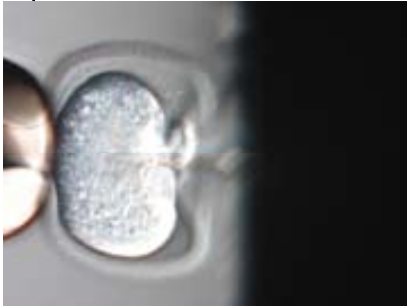
Figura 4.60: Imágenes ópticas tomadas durante los test de inserción realizados para puntas de micro/nanopipetas de óxido para la punta de 4 mm de ancho afilada (a) 5°, (b) 15°, y las puntas afiladas 15° de (c) 2 \mu\text{m} y (d) 10 \mu\text{m} . Las puntas que atravesaron sin dificultad la zona pelúcida y la membrana de los embriones fueron la de 2 \mu\text{m} con 15° y de 4 \mu\text{m} con 5°.
