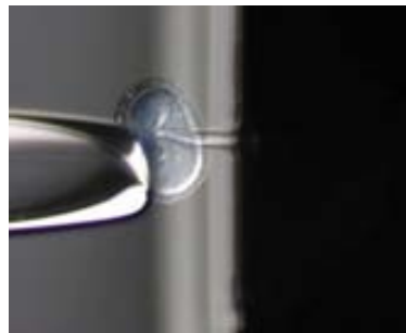
Figura 4.60: Imágenes ópticas tomadas durante los test de inserción realizados para puntas de micro/nanopipetas de óxido para la punta de 4 mm de ancho afilada (a) 5°, (b) 15°, y las puntas afiladas 15° de (c) 2 \mu\text{m} y (d) 10 \mu\text{m} . Las puntas que atravesaron sin dificultad la zona pelúcida y la membrana de los embriones fueron la de 2 \mu\text{m} con 15° y de 4 \mu\text{m} con 5°.
