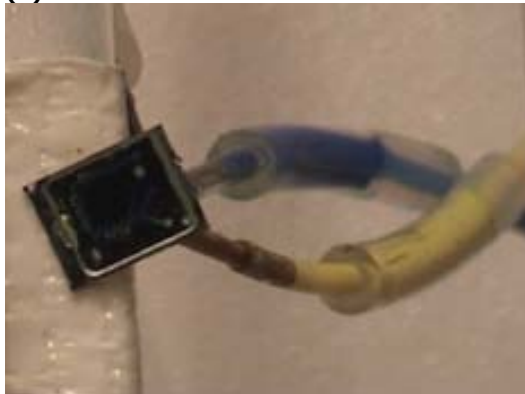
Figura 5.5: Imágenes ópticas de (a) el montaje experimental mostrando la conexión entre el chip, la microbureta y las tintas de colores y (b) detalle del experimento realizado con el micromezclador.
