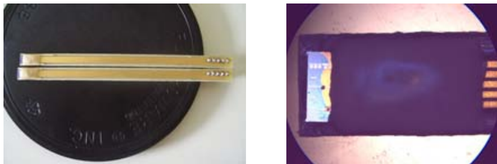
Figura 5.28: (a) Imagen de dos chips con microelectrodos encapsulados a dos tiras de PCB y (b) imagen óptica obtenida con una lupa del detalle de uno de los chips encapsulados.
