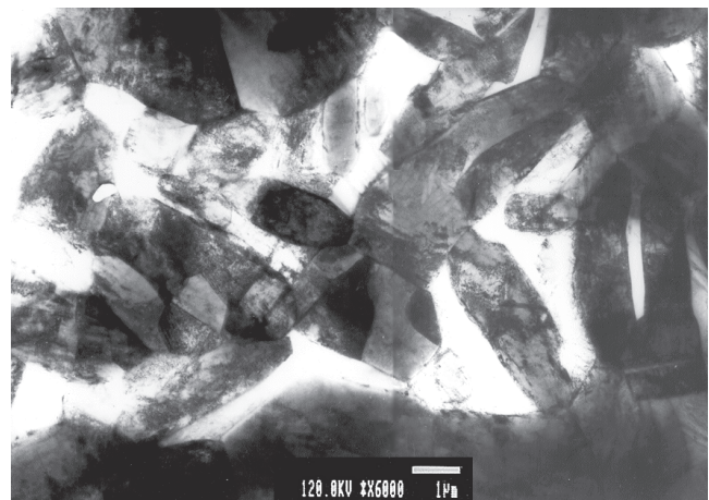
Figura 3.21 Formación de granos de fase \alpha secundaria por crecimiento de placas de Widmanstätten en fase \beta .
