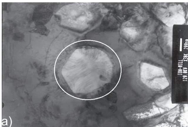
Figura 3.23 a) Matriz de fase \alpha del titanio de una muestra Ti64_900_1; b) Diagrama de difracción de electrones con eje de zona [2\bar{1}\bar{1}0] .
