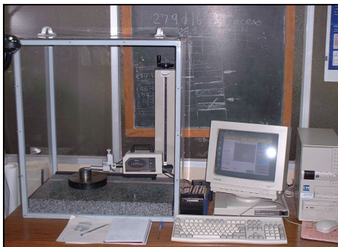
Figura 2.7 Rugosímetro utilizado para realizar las mediciones cuantitativas de rugosidad.
