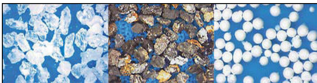
Figura 2.6 Morfología característica de las partículas abrasivas de \text{Al}_2\text{O}_3 (izquierda), SiC (centro) y \text{ZrO}_2\text{-SiO}_2 (derecha). Fuentes: [PW-TRE],[PW-NAV],[PW-SEP].
