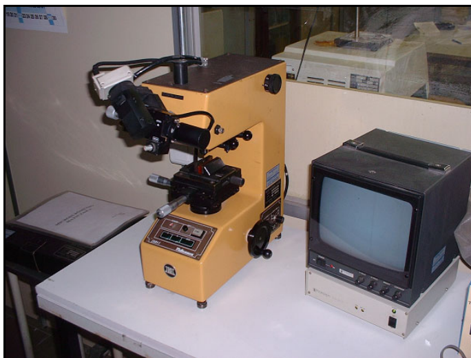
Figura 2.5 Microdurómetro empleado para evaluar la dureza del Ti c.p.
